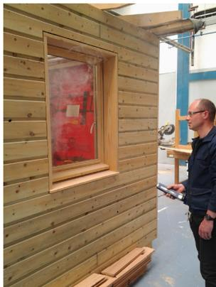
une structure fermée pour les tests étanchéité à l'air 'Blower door'
